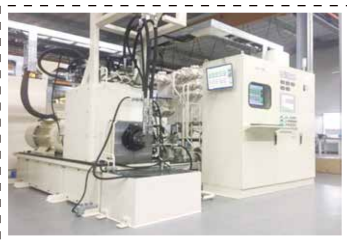
▲ Испытательный стенд для проверки моторов
