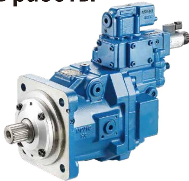
Аксиально-поршневой мотор с наклонным диском серии HM7V - это мотор переменного рабочего объема с широким применением для открытого и замкнутого контуров. Конструкция наклонного диска обеспечивает компактный мотор с высокой удельной мощностью. Эта серия применима к строительной технике и промышленным транспортным средствам.
