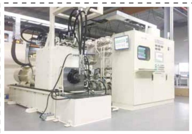
▲ Испытательный стенд для проверки моторов
