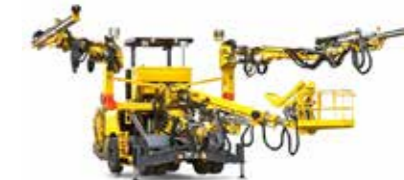
Буровая установка для бурения горных пород
