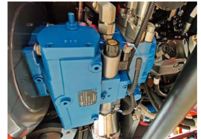
HP4VG100: для подъемной платформы
