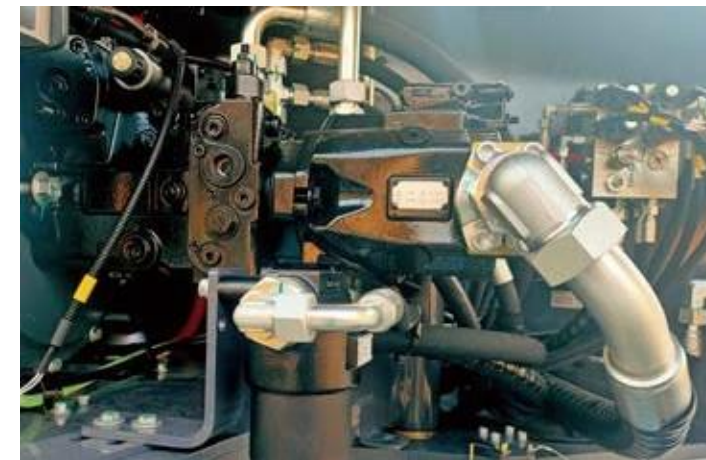
HP4VG60: для подъемной платформы
