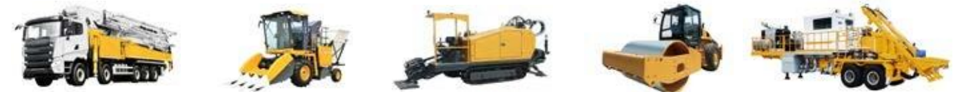
Автобетононасос Сельскохозяйственный уборочный комбайн Буровая установка горизонтального бурения Дорожный каток Перекачивающая станция
